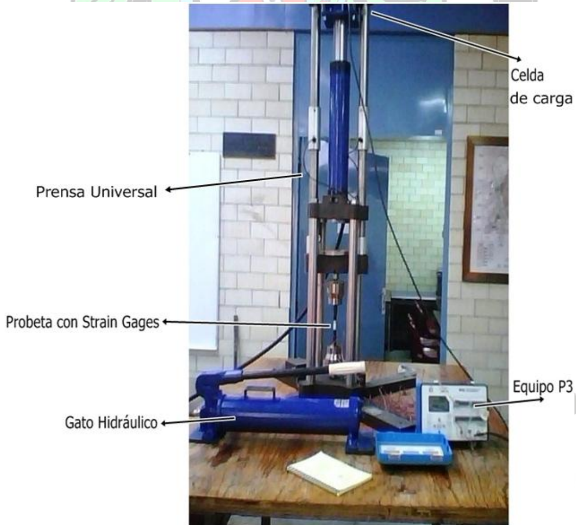
Fig. 1.- Equipo Instalado para llevar a cabo la prueba.
