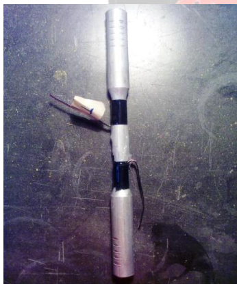
Fig.- 2.0.- Probeta de acero instrumentada
