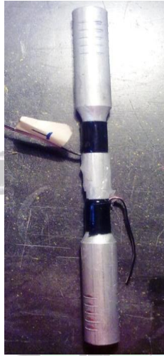
Fig. 2.1.- Strain Gages Instalado
